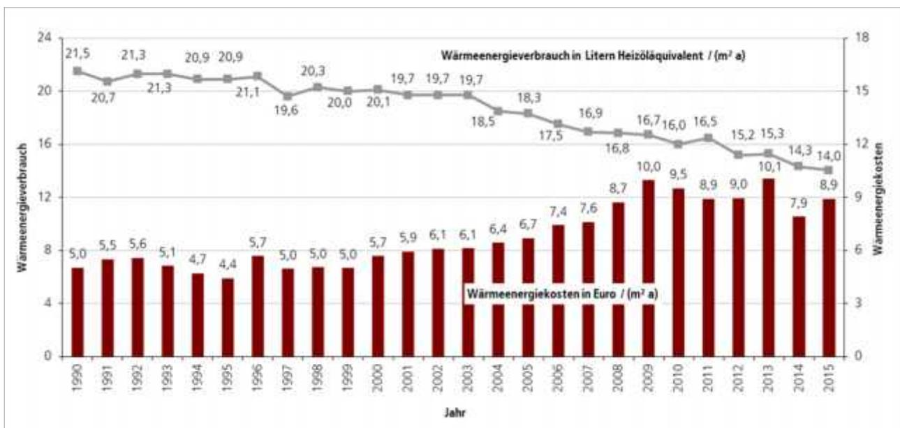
Die Abbildung 1.3.2 zeigt die Entwicklung des spezifischen, witterungsbereinigten Wärmeenergieverbrauchs und die auf dem tatsächlichen Verbrauch basierenden CO<sub>2</sub>-Emissionen von 1990 bis 2015 für die energetisch überwachten Gebäude.
