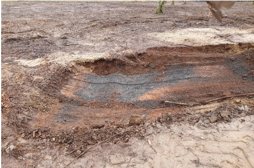
Abb. 3: Beispielhafte Tiefenlage der schlackenführenden Schicht unter Oberbodenbedeckung im Bereich der Fläche 3
