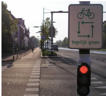
Niederländisches Straßenschild, das Grün für den Radverkehr in alle Richtungen gleichzeitig anzeigt
